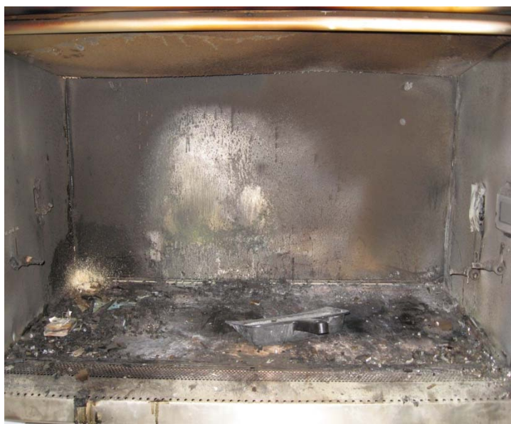
图 3. 不要让您的安全柜变成这样！因在安全柜内使用明火和酒精而造成的火灾。
